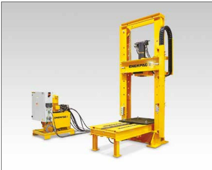
▲ Для морских сооружений потребовалась сборка и проверка цилиндров большой грузоподъемности с возвратной пружиной. Для этого был спроектирован специальный 100-тонный пресс с подвижной станиной с длинноходовым цилиндром. Управление и контроль всех перемещений осуществлялись с помощью ПДУ с микропроцессорным управлением.
