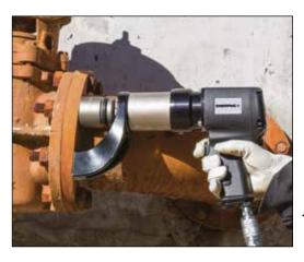
◀ Гайковерт РТW1000 позволяет легко справиться с техническим обслуживанием таких фланцев.
