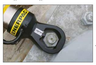
Сильно заржавевшие и изношенные гайки легко срезаются и удаляются при помощи гайкореза серии NS.
