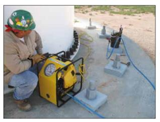
◀ Насос ZUTP-1500 отличается высокой прочностью, малой массой и компактностью, позволяющей выполнять работы в условиях недостатка места. При использовании для работ по затяжке болтов в удаленных местах он может обеспечивать ускорение выполнения работ вдвое по сравнению с конкурирующими моделями.
