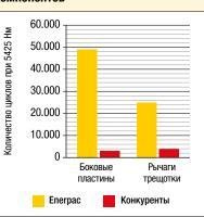
\* Усредненные результаты испытаний, в которых три 46-мм кассеты UltraSlim Епеграс и три 46-мм кассеты основных конкурентов тестировались при крутящем моменте 5425 Нм в течение 50.000 циклов. Боковые пластины кассет Епеграс ни разу не сломались в процессе испытаний.
