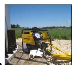
Насос ТQ-700Е и гайковерты серии W - эффективная комбинация для обслуживания ветроэнергетических установок. ▶
